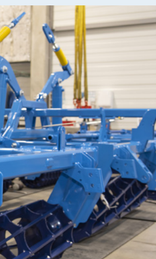
» Kompaktomat z firmy Farnet – stroj pro předseťovou přípravu půdy.
