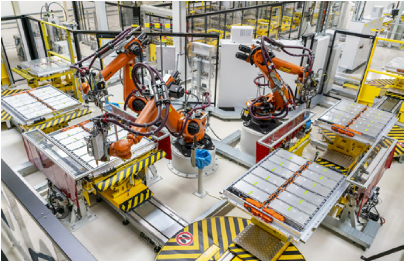
>> Automobilky jako Škoda Auto vyrábějí finální bateriové komplety. FOTO: ŠKODA AUTO
