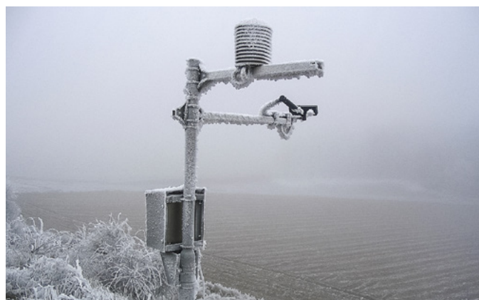
>> Meteorologické stanice vybavené speciálním softwarem vyhodnocují a predikují stav vozovek. FOTO: CROSS ZLÍN
