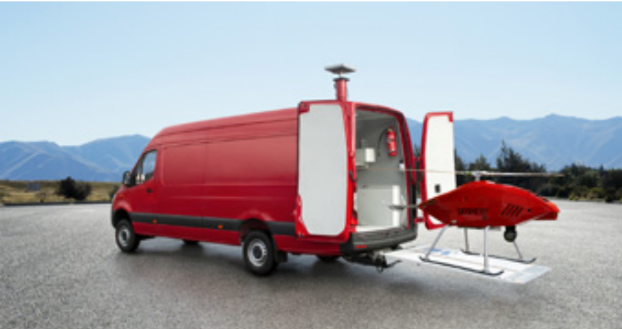
» Liaz dodává svůj bezpilotní vrtulník také ve verzi, v níž je řídicí centrum zabudované do dodávky. FOTO: LIAZ
