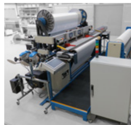
» Pneumatický tkací stroj DIFA dokáže vyrobit lehkou a skladnou 3D tkaninu, která může nahradit třeba hever při zvedání letadla. Foto: VÚTS
