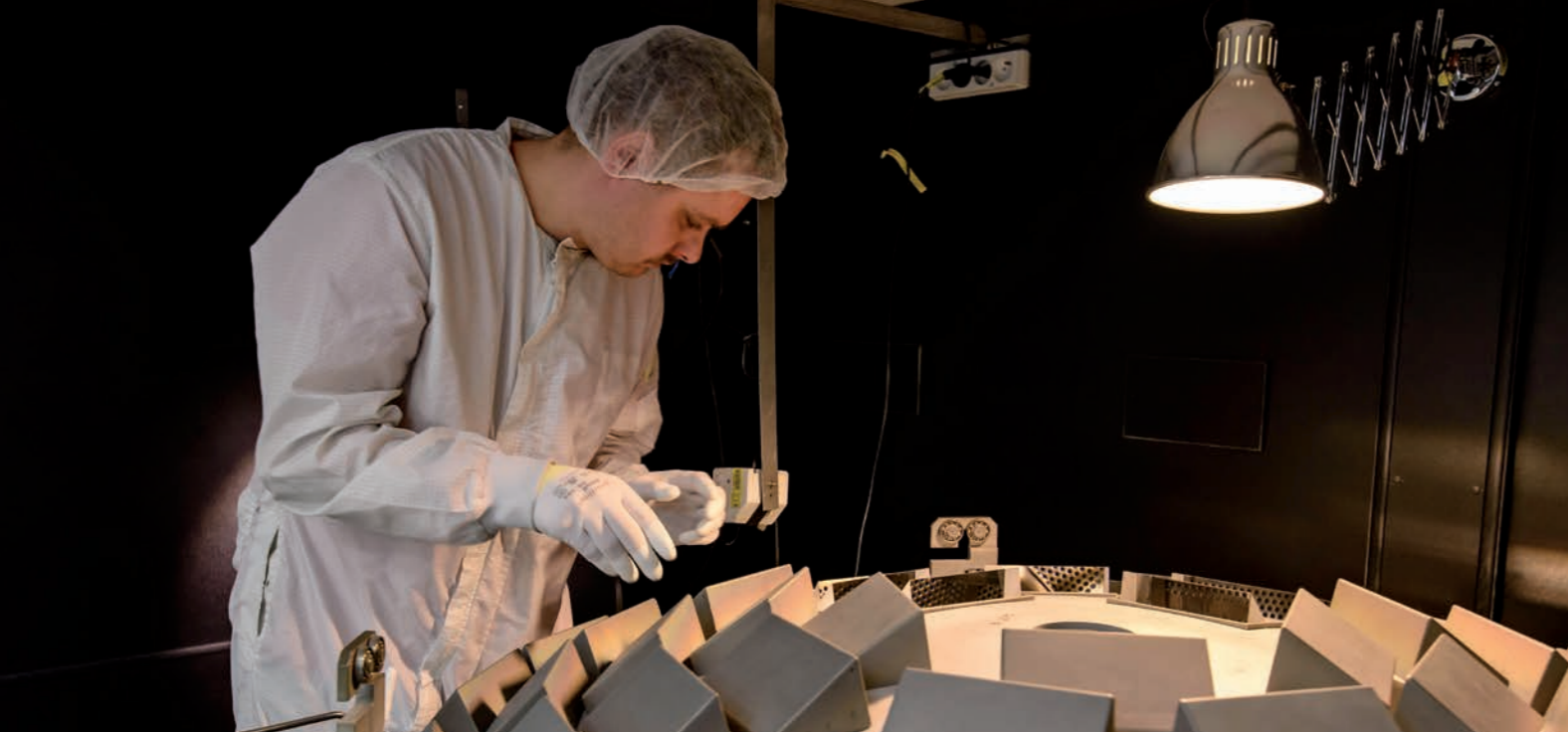
» Nanášení ultratenkých optických vrstev ve speciálních vakuových aparaturách Syrus. Foto: Meopta
